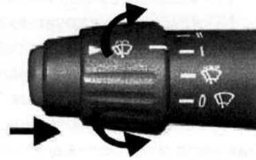
Рис. 1.18. Комбинированный переключатель – управление стеклоочистителем и стеклоомывателем
