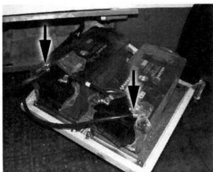
Рис. 1.7. Места подключения внешнего источника питания
