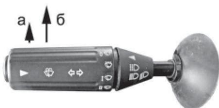
Рис. 1.51. Комбинированный переключатель - переключение света фар
