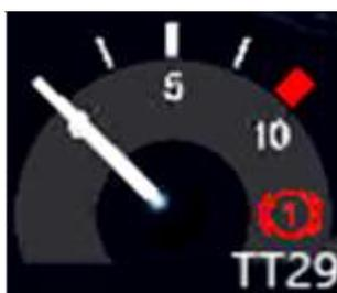
Рис. 1.16. Указатель давления в 1-ом контуре
