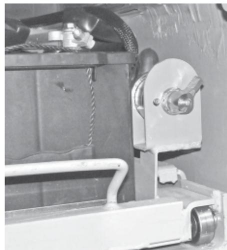
**Рис. 1.7. Механический выключатель аккумуляторных батарей размещен в аккумуляторном отсеке**
