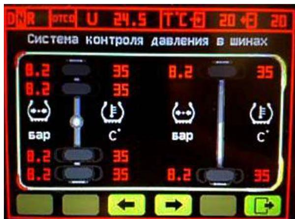
Рис. 1.25. Мониторинг давления в шинах
