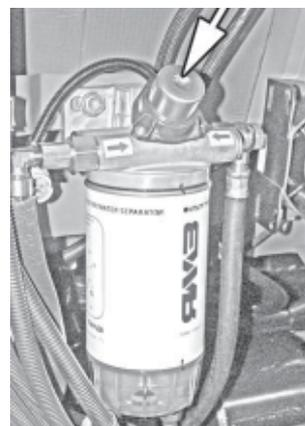
**Рис. 1.64.** Подкачивающий насос на топливном фильтре-водоотделителе
