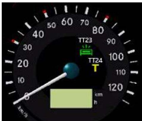
Рис. 1.13. Указатель спидометра с одометром
