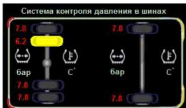
Рис. 1.26. Индикация низкого давления
