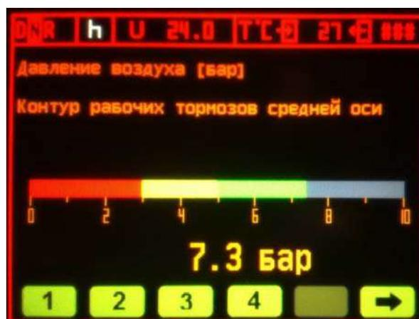
Рис. 1.32. Давление воздуха в контуре тормоза задней оси
