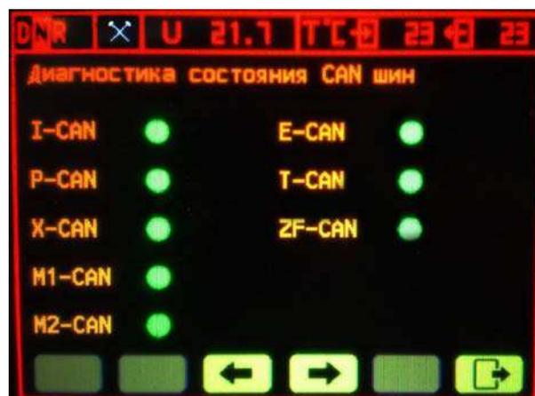
Рис. 1.36. Диагностика состояния CAN-шин
