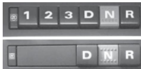
**Рис. 1.65. Клавишный переключатель автоматической коробки передач (в шестиклавишном и трёхклавишном исполнении)**
