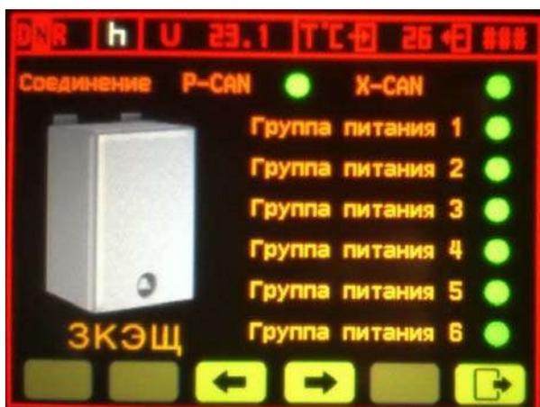
Рис. 1.38. Диагностика заднего электрощита
