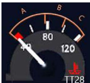
Рис. 1.15. Указатель температуры охлаждающей жидкости
