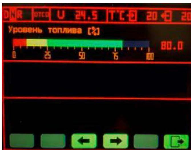
Рис. 1.24. Мониторинг уровня топлива в баке
