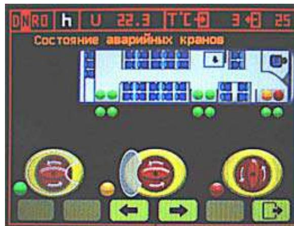
Рис. 1.31. Состояние аварийных кранов
