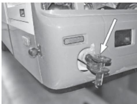
Рис. 1.81. Заднее буксирное устройство
