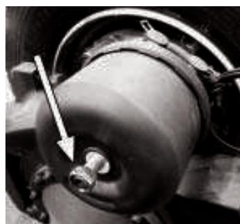
Рис. 1.84. Силовой винт тормозной камеры
