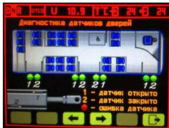
Рис. 1.37. Диагностика датчиков дверей
