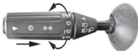
Рис. 1.53. Комбинированный переключатель - управление стеклоочистителем и стеклоомывателем
