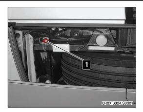
Der Fremdbefüllungsanschluss befindet sich hinter der Bugmittelklappe.
