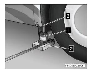
▶ Wenn an dem benötigten Wagenheber-Ansetzpunkt 3 nicht genügend Bodenfreiheit vorhanden ist, um den Wagenheber 1 auf der Holzplatte 2 an der Karosserie anzusetzen, muss mit dem entsprechenden Rad auf den mitgelieferten Auffahrkeil aufgefahren werden.
