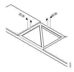
**ВНИМАНИЕ!** Убедитесь, что на напольную панель со всех сторон нанесено защитное покрытие, чтобы полностью предотвратить проникновение влаги. На заводе-изготовителе напольное покрытие приклеивается к панели при помощи клея на водной основе. В случае проникновения влаги клей растворяется, и покрытие отклеивается.
