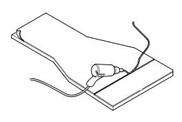
18 Проверьте целостность антикоррозийного покрытия, нанесенного на раму пола и опору напольной панели. Нанесите дополнительное антикоррозионное покрытие на те участки, где это необходимо.
