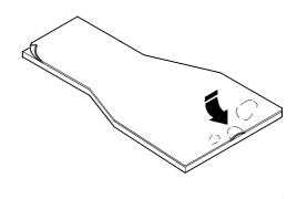
17 При помощи специального сварочного пистолета приварите кромки напольного покрытия к панели, обрежьте остаток сварочного стержня и заровняйте стык между панелями.
